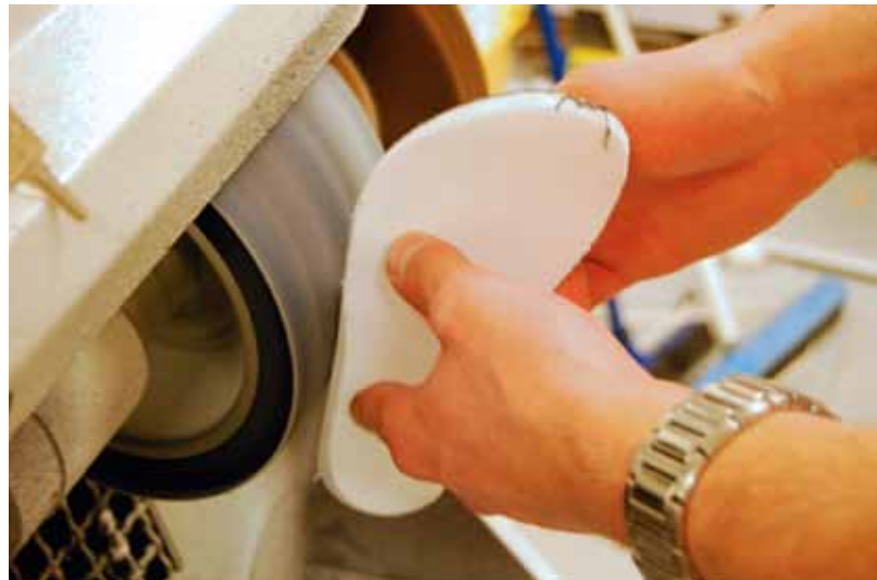
En färdig fotbädd slipas till och formas för att stödja upp fotens valv med rätt mängd stöd på rätt del av foten. Ett noggrant hantverksarbete.
