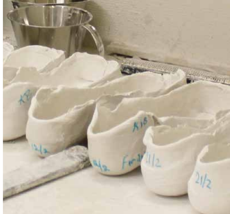
Gipsmallar uppräddade i väntan på att fyllas med ytterligare gips. Gipset som fylls i formarna blir en exakt kopia av respektive fot.
