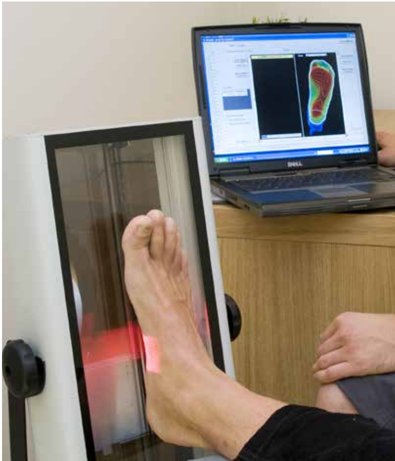
Avscanning av foten med en 3D laserscanner. Laserstrålar läser av fotens form och bygger därefter upp en tredimensionell bild av fötterna.
