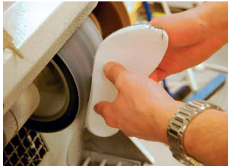
En färdig fotbädd slipas till och formas för att stödja upp fotens valv med rätt mängd stöd på rätt del av foten. Ett noggrant hantverksarbete.
